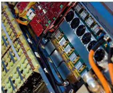
Leistungselektronische Komponenten in einem „Smart Battery Module“ für Hybrid- und Elektrofahrzeuge. Bild: Fraunhofer IISB.
