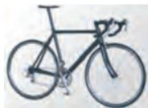
einen neuentwickelten 828 Gramm (entspricht 6 Äpfeln) leichten CFK-Fahrradrahmen begutachten und sich mit dem Konstrukteur unterhalten.
