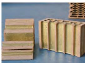
**Hochwärmedämmende Mauerziegel und Bindebaustoffe**
